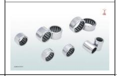
冲压外圈滚针离合器由薄壁冲压外圈、塑料保持架、弹簧及滚针 组合。冲压外圈内径面上具有夹紧滚针的斜面。塑料保持架上装有金 属弹簧,塑料保持架保持滚针运动正确,滚针则起夹紧元件作用。此 类轴承具有最小径向截面高度。
